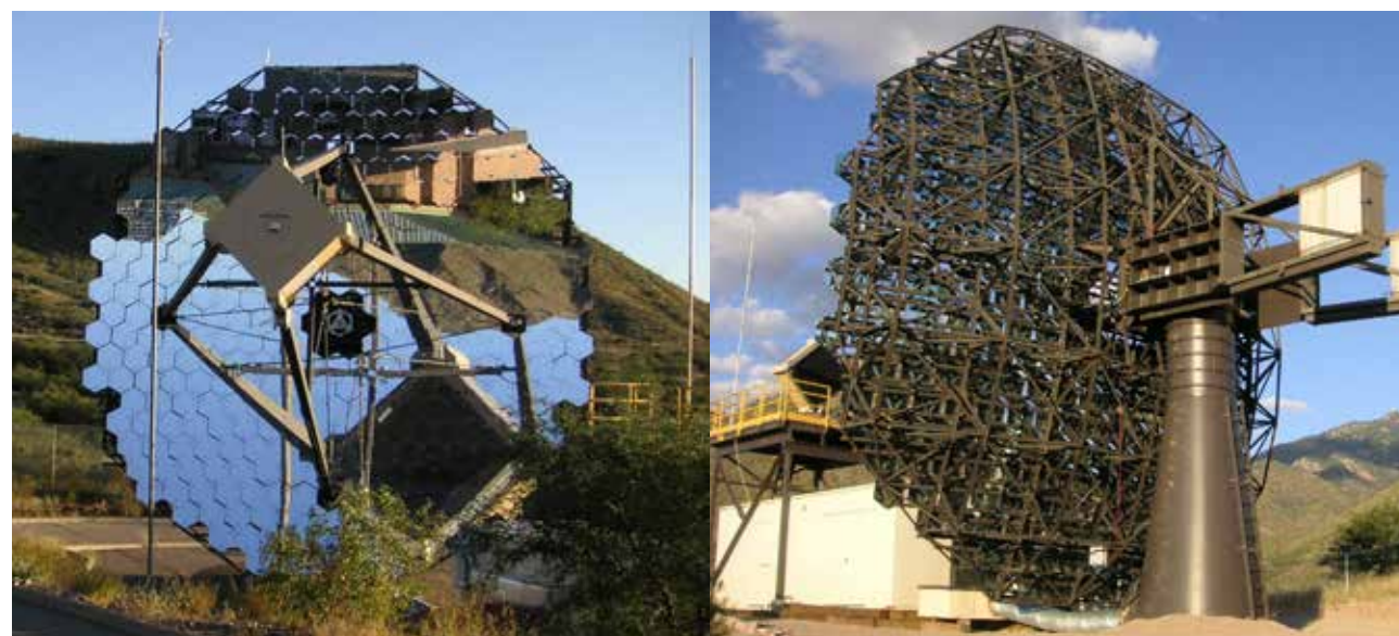
Ett av flera Tjerenkovteleskop vid VERITAS-anläggningen på Mount Hopkins, söder om Tucson i Arizona, inte långt från Kitt Peak-observatoriet. Varje teleskop är 12 meter i diameter och dess enda spegel består av ett stort antal sexkantiga segment. Den kvadratmeterstora kameran finns i den fyrkantiga lådan som också syns reflekterad i spegeln. Sedan 2018 nyttjas dessa teleskop även för intensitets-interferometri.
